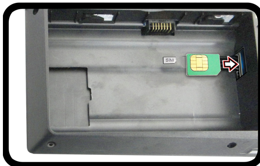
Abb. 35 - Herausnehmen des Akkus und einsetzen der USIM-Karte
