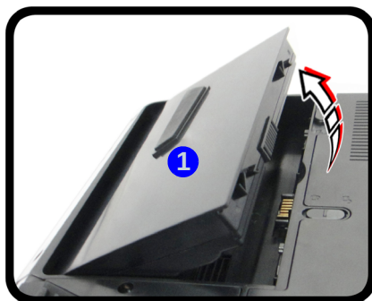
Abb. 35 - Herausnehmen des Akkus und einsetzen der USIM-Karte
