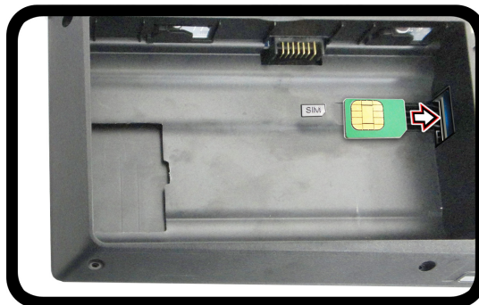
Figure 35 - Retirer la batterie et insérer la carte USIM
