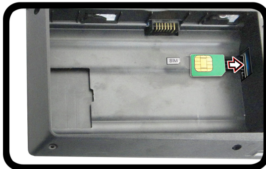
Figura 35 - Rimozione della batteria e inserimento della carta USIM
