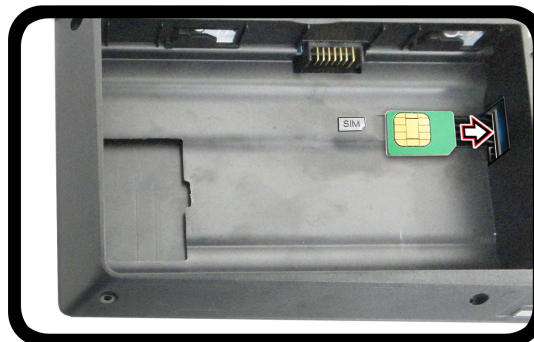
Figura 35 - Quitar la batería e insertar la tarjeta USIM
