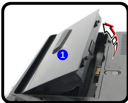
Figura 35 - Rimozione della batteria e inserimento della carta USIM
