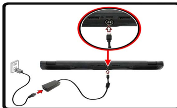
Figure 1 - Ouvrir le couvercle/LCD/ordinateur avec un adaptateur AC/DC branché
