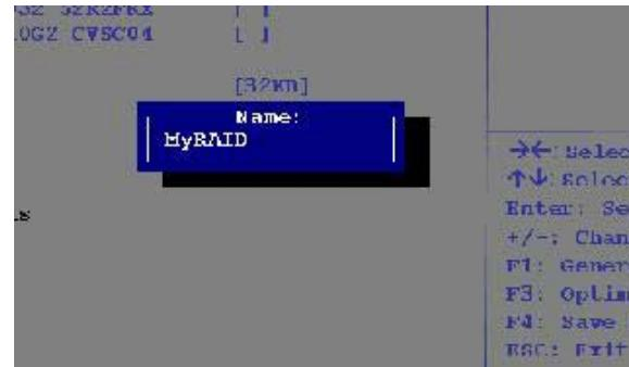
**Figura 2 - Assegnare un nome al volume RAID (Advanced > Intel(R) Rapid Storage Technology)**
