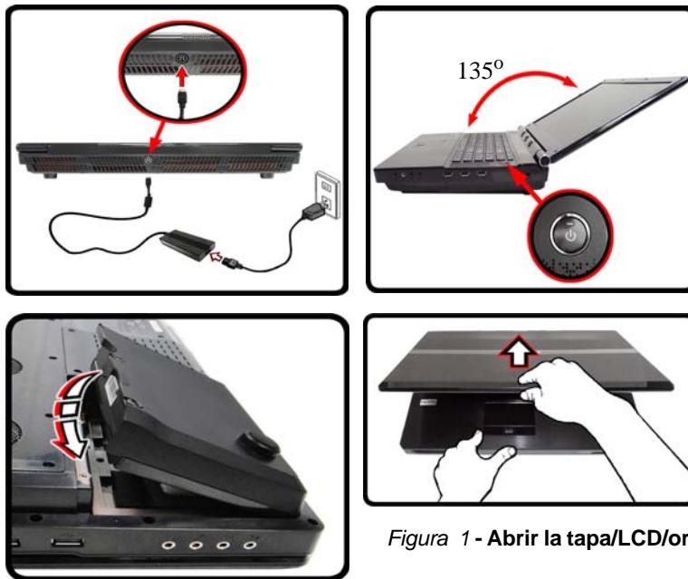
Figura 1 - Abrir la tapa/LCD/ordenador con el adaptador AC/DC enchufado
