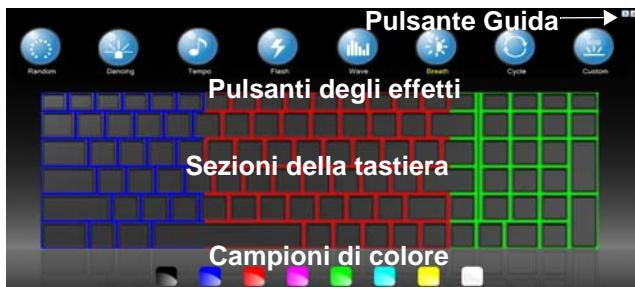
Figura 7 - Applicazione di retroilluminazione della tastiera
