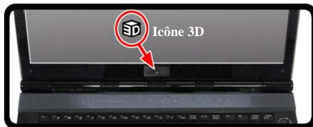
Figure 15 - Emplacement de l'émetteur IR
