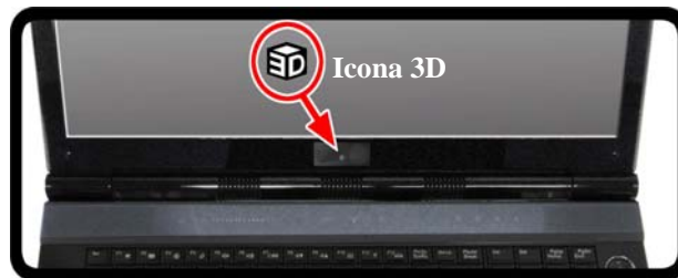
Figura 12 - Punto di emissione infrarossi
