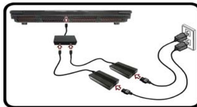
Figura 16 Doppio adattatori & convertitore di energia
