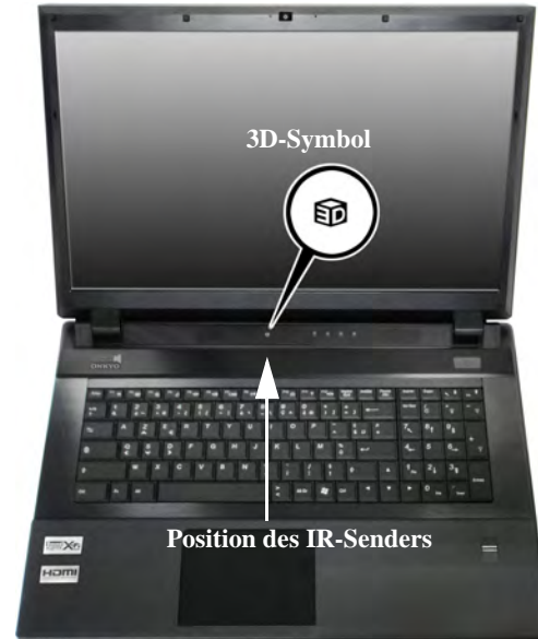
Abb. 12 - Position des IR-Senders
